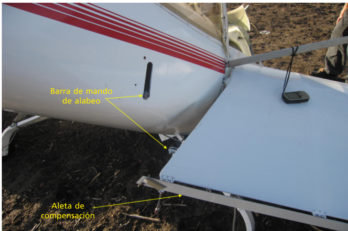
Fotografía 2. Fotografía del plano inferior y los anclajes
