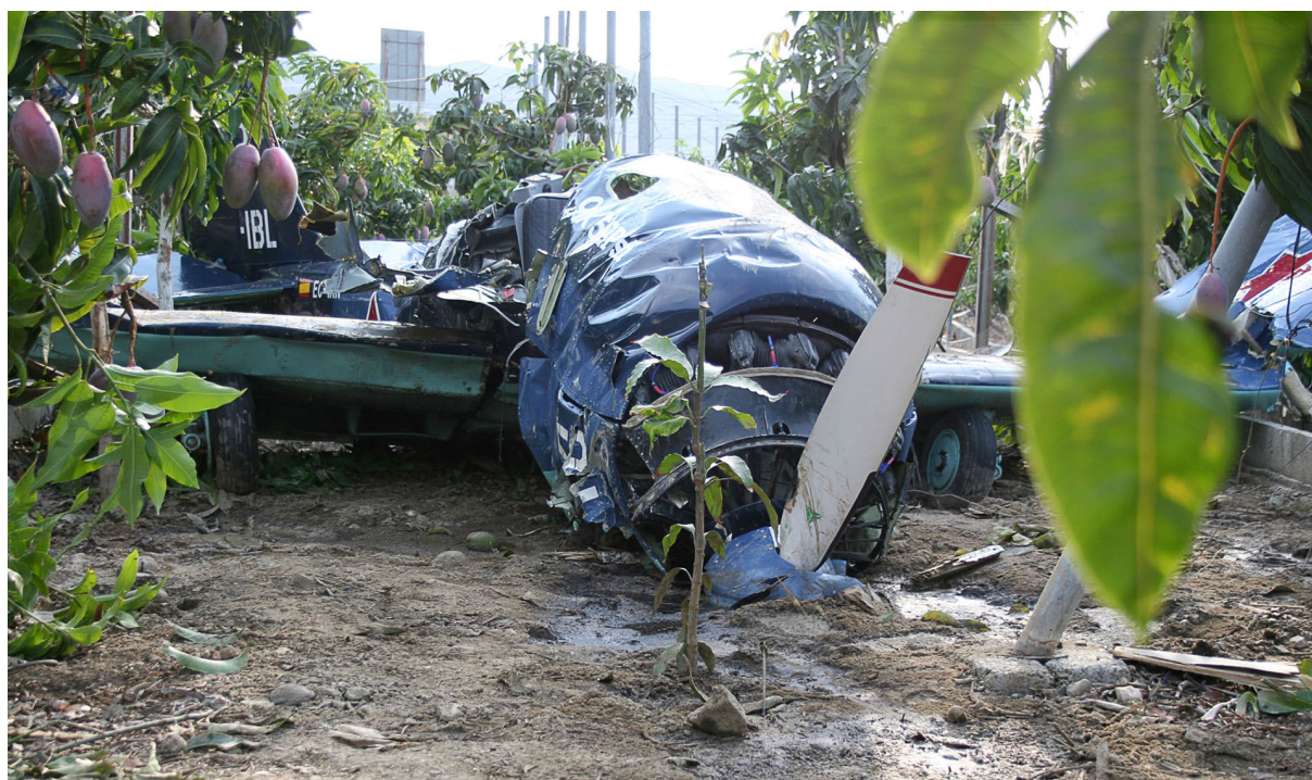
Figura 3. Estado y daños de la aeronave Yak-52, EC-IAN
