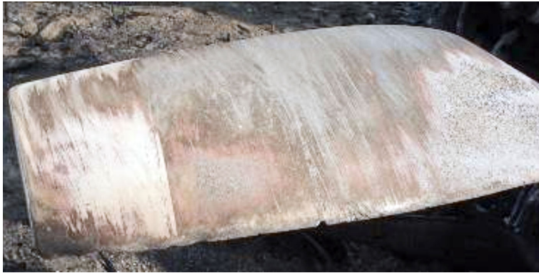
Figura 3. Detalles de marcas en el intradós de una de las palas de la hélice
