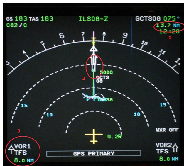
Figura 2. Simulación de la pantalla del ND en modo arco durante la aproximación. Cedida por Airbus
