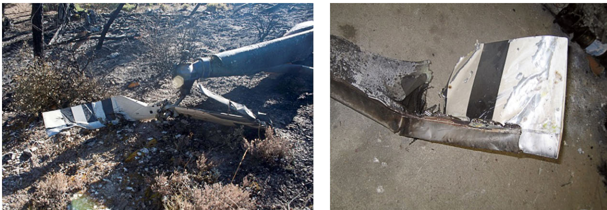
Figura 24. Restos del rotor de cola
