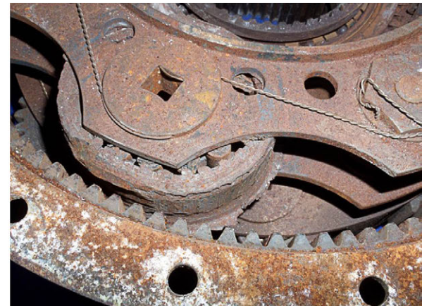
Figura 5.3. Detalle engranajes planetario inferior
