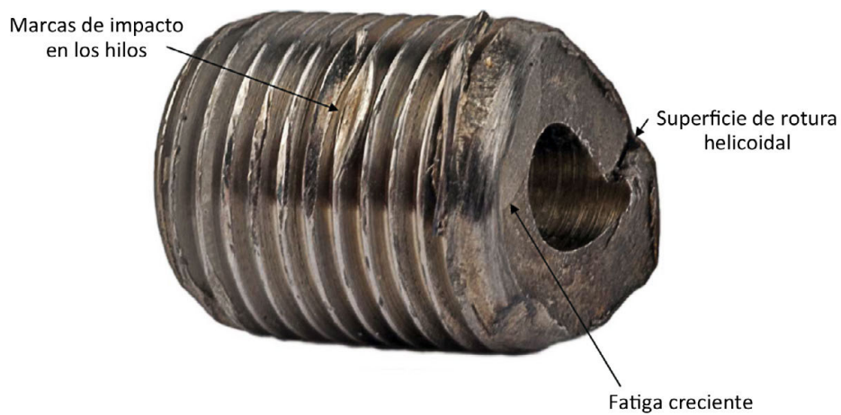
Figura 10. Extremo roscado en la parte delantera del eje
