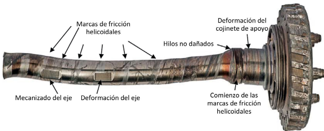
Figura 8. Fragmento trasero del eje de potencia
