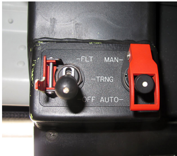
Figura 2. Posiciones del interruptor del motor
