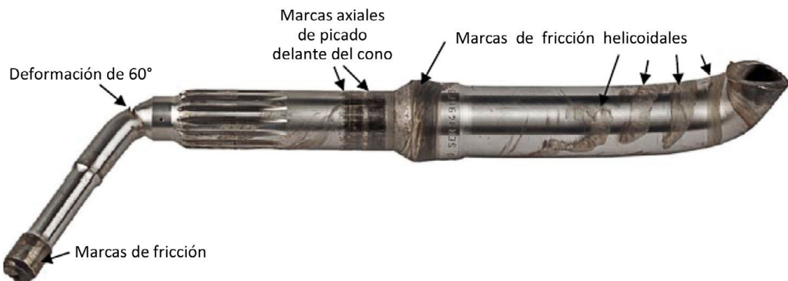
Figura 9. Fragmento delantero del eje de potencia
