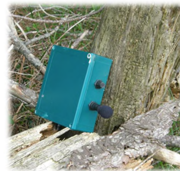
Figura 3.14. Grabadora de ultrasonidos de murciélagos SM2BAT utilizada en este trabajo, por J.T. Alcalde.
