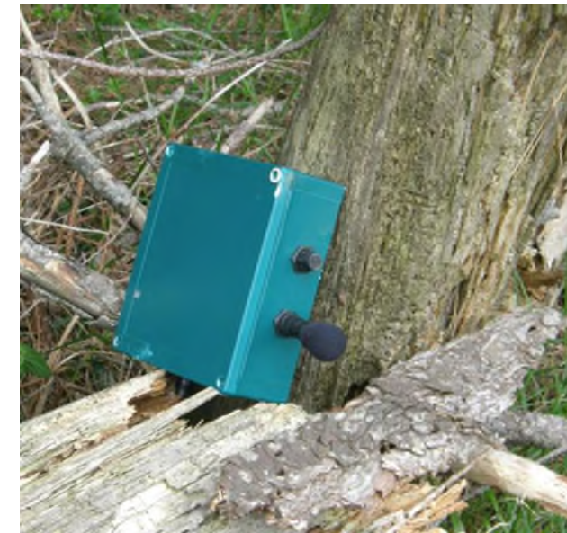
Figura 3.15. Grabadora de ultrasonidos de murciélagos SM2BAT utilizada en este trabajo.
