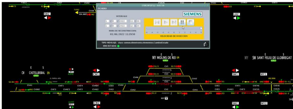
Figura 12. Datos extraídos de la moviola a las 11:19:50, instante en el que el tren 77721 ocupa el CVAE4 y se detiene ante la señal E4.
