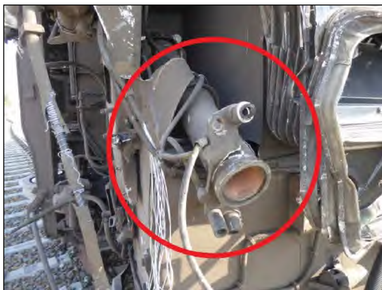
Imagen 19 Detalle del acoplamiento semipermanente. Foto tomada con la cabeza motriz volcada sobre su lado derecho.
