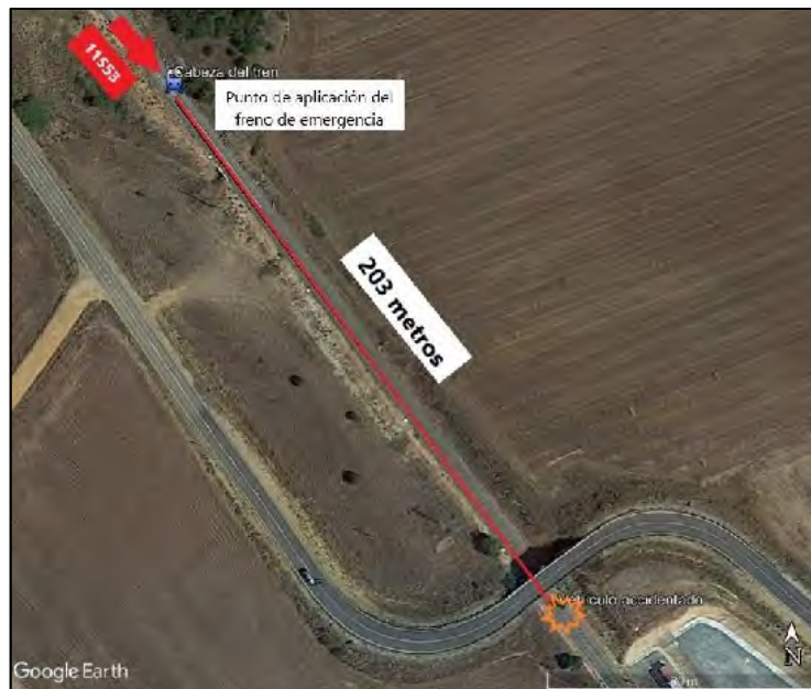
Imagen 26 Distancia recorrida por el tren desde la aplicación del freno de emergencia hasta el punto de colisión.
