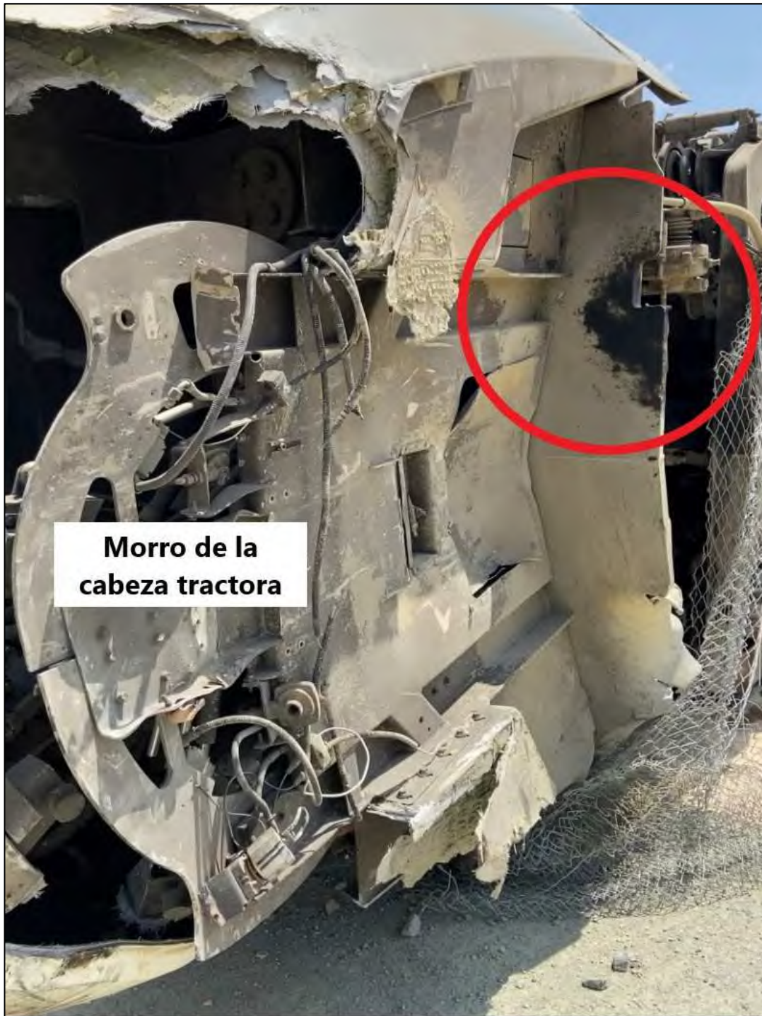
Imagen 20 Detalle de la mancha de aceite transferido al chasis de la motriz. Foto tomada con la cabeza motriz volcada sobre su lado derecho.
