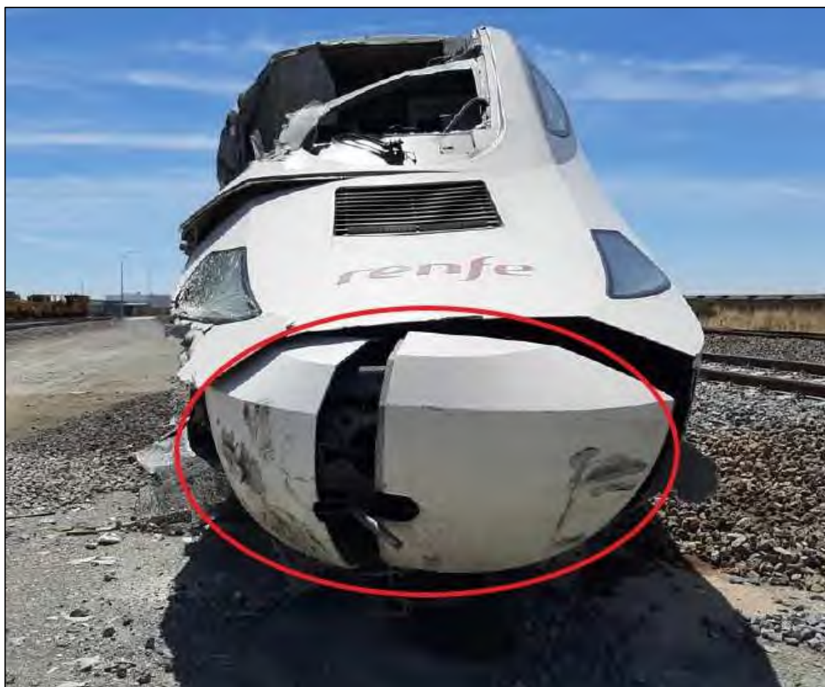
Imagen 21 Detalle del impacto de los neumáticos en el morro de la cabeza motriz. Se aprecian los graves daños en la cabina de conducción, Foto tomada con la cabeza motriz levantada.
