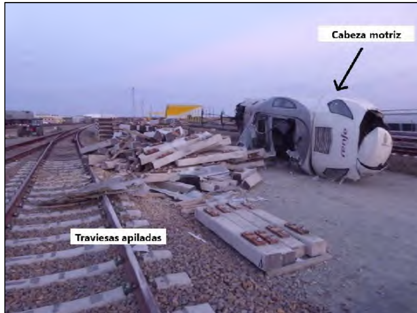
Imagen 18 Situación final de la cabeza motriz tras el impacto con las traviesas apiladas
