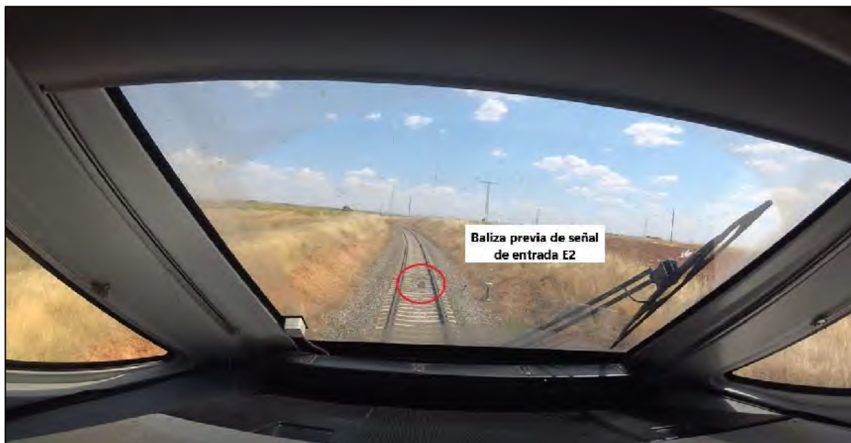
Imagen 33 Vista desde la cabina de la baliza previa de la señal E2. Aún no se divisa el paso superior.
