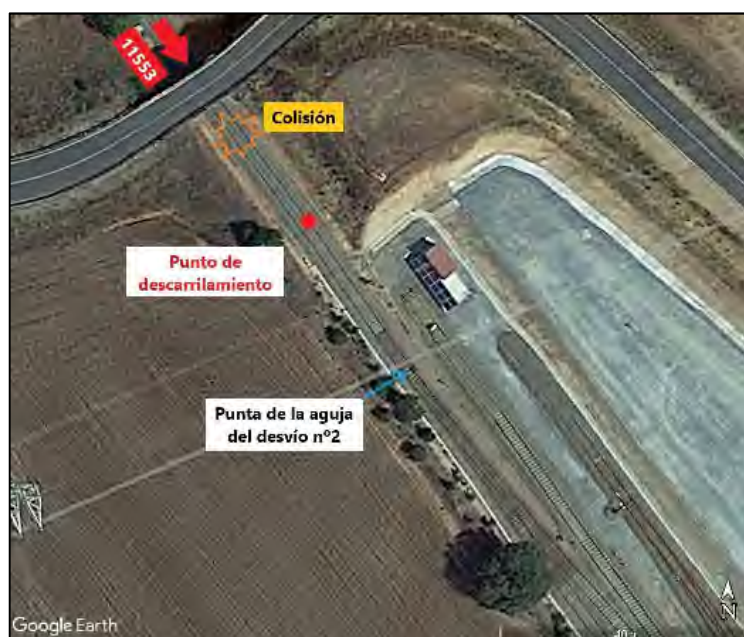
Imagen 27 Localizaciones de los puntos de colisión, descarrilamiento y punta de la aguja.
