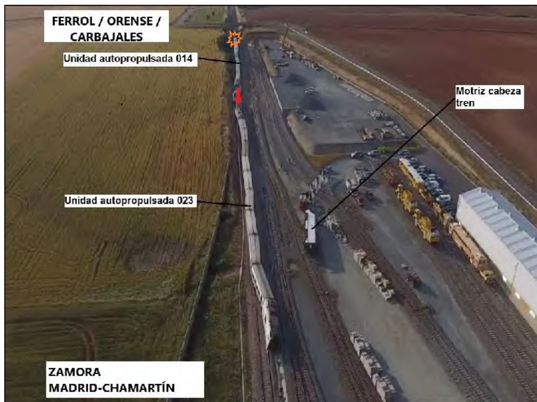
Imagen 8 Posición final de las 2 ramas y de la cabeza motriz. Fotografía aérea.
