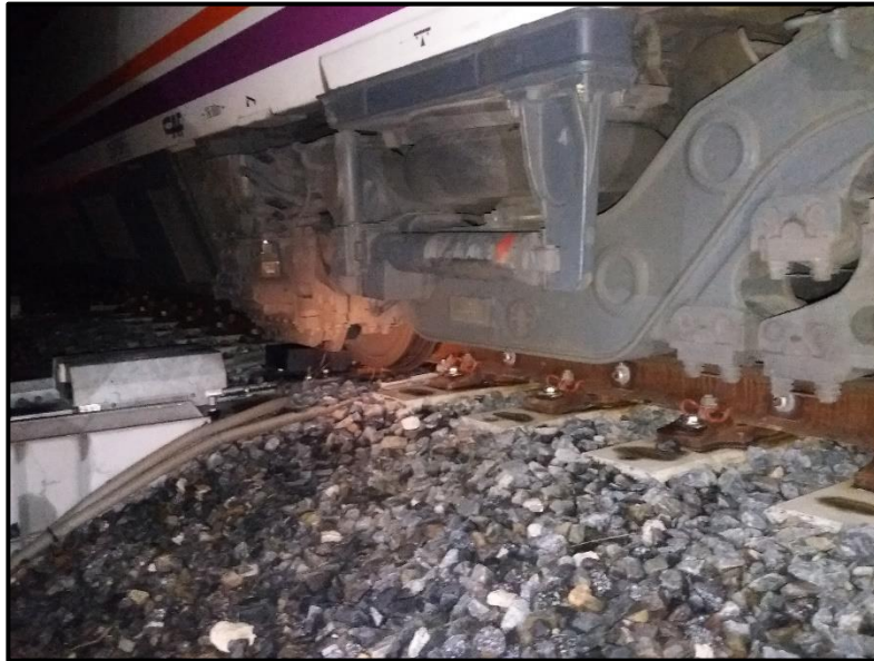
Imagen 9 Primer bogie descarrilado
