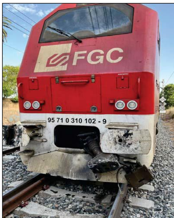
Figura 3 Daños en el tren 95172 tras el impacto
