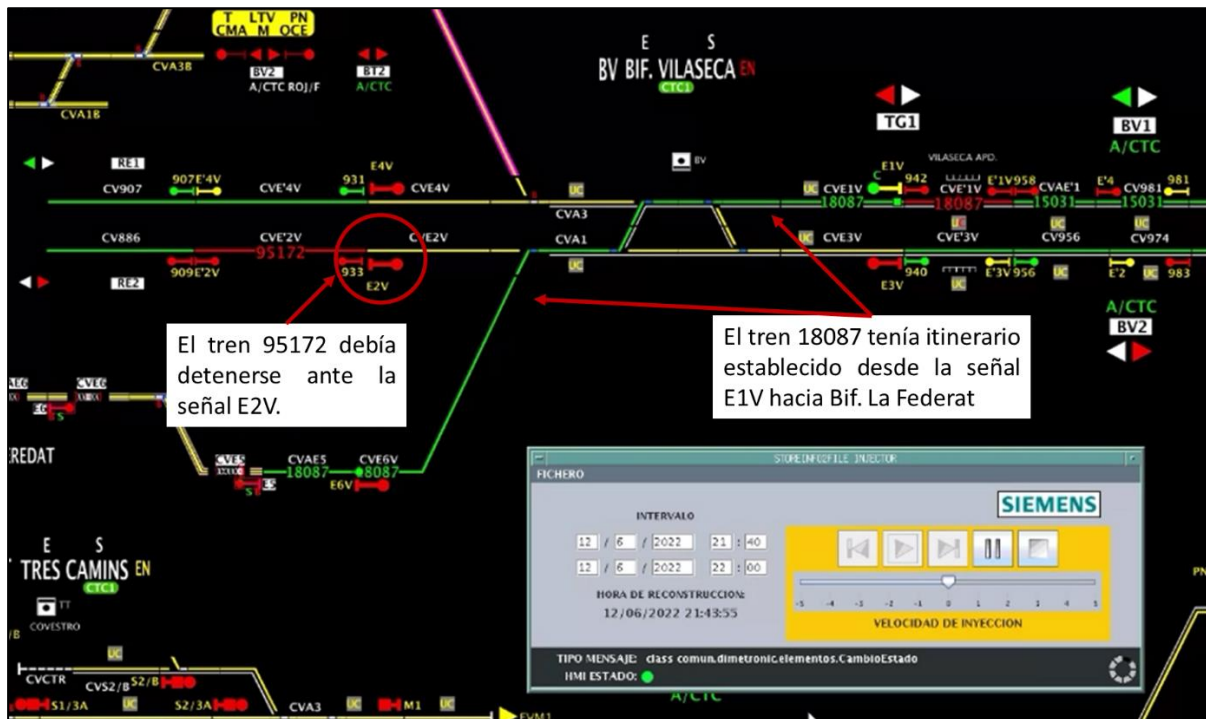
Figura 17 Situación del enclavamiento momentos antes de la colisión
