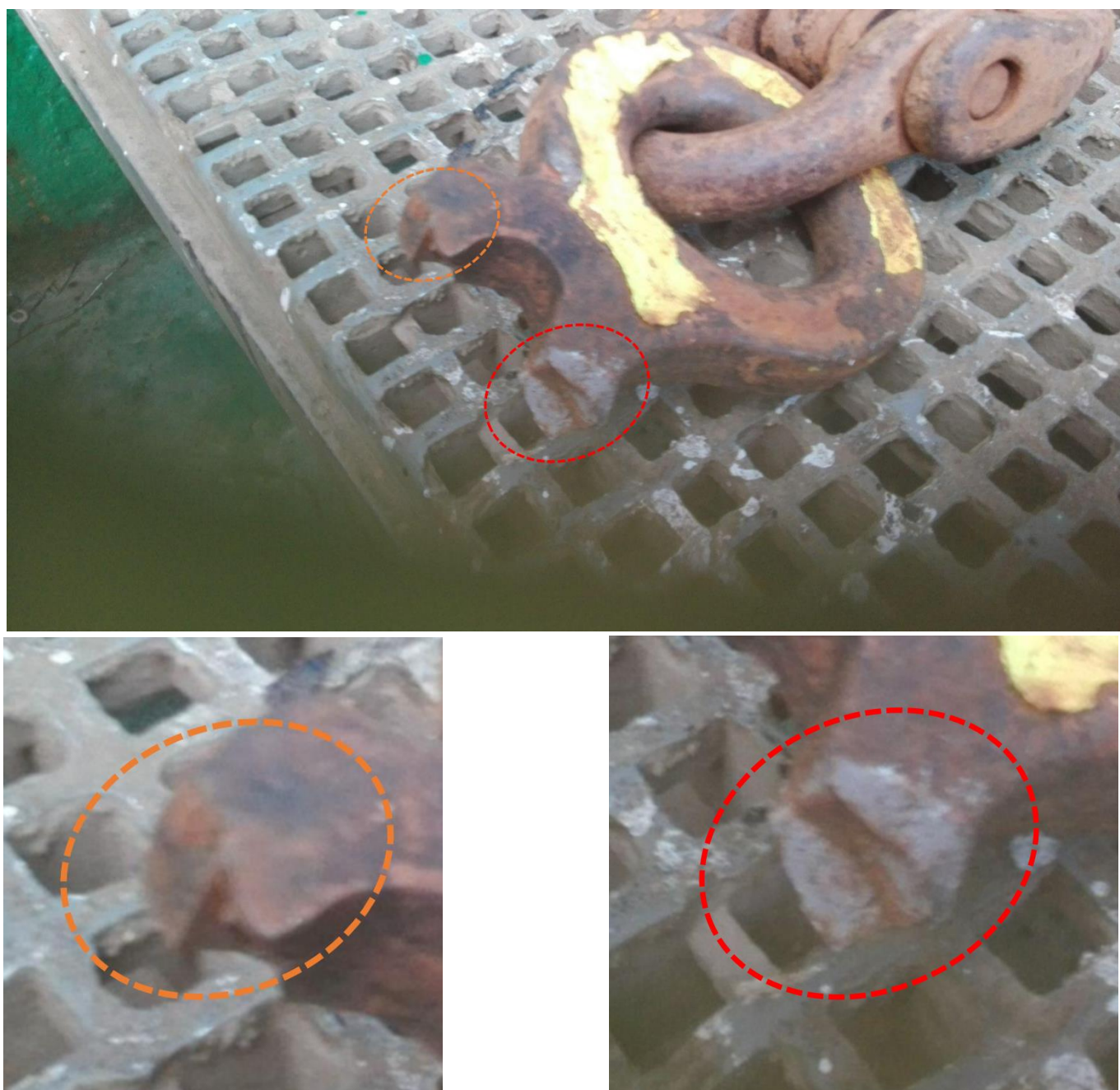
Figura 9. Resto del gancho que falló, y detalles de las zonas de rotura en su cuello. Fuente: Servicio de Prevención ajeno ASPY.
