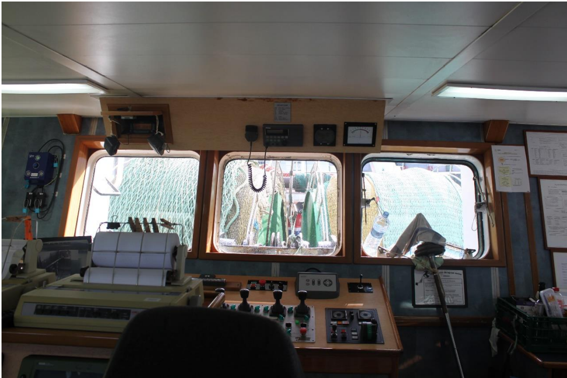
Figura 11. Visibilidad desde el Puente de la zona de maniobra. En primer plano, consola de gobierno de maquinillas.
