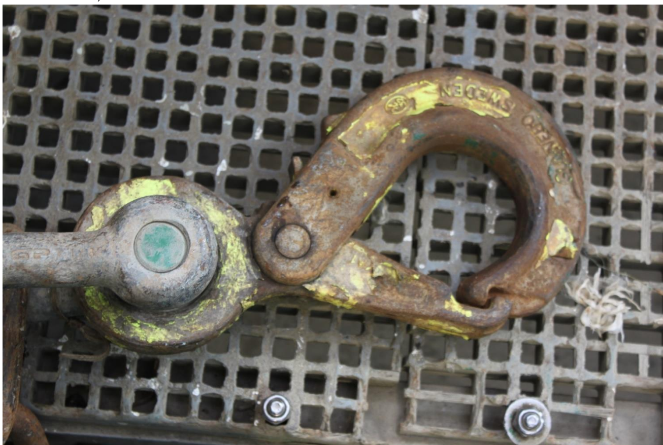
Figura 6. Gancho en operación a bordo del KAXARRA, idéntico al que falló.
