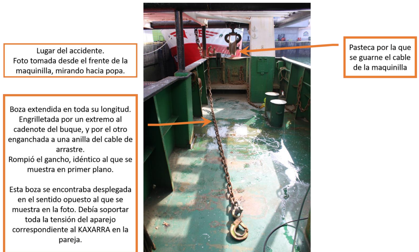
Figura 5. Detalle de la boza de cadena. Nótese el gancho en primer plano.
