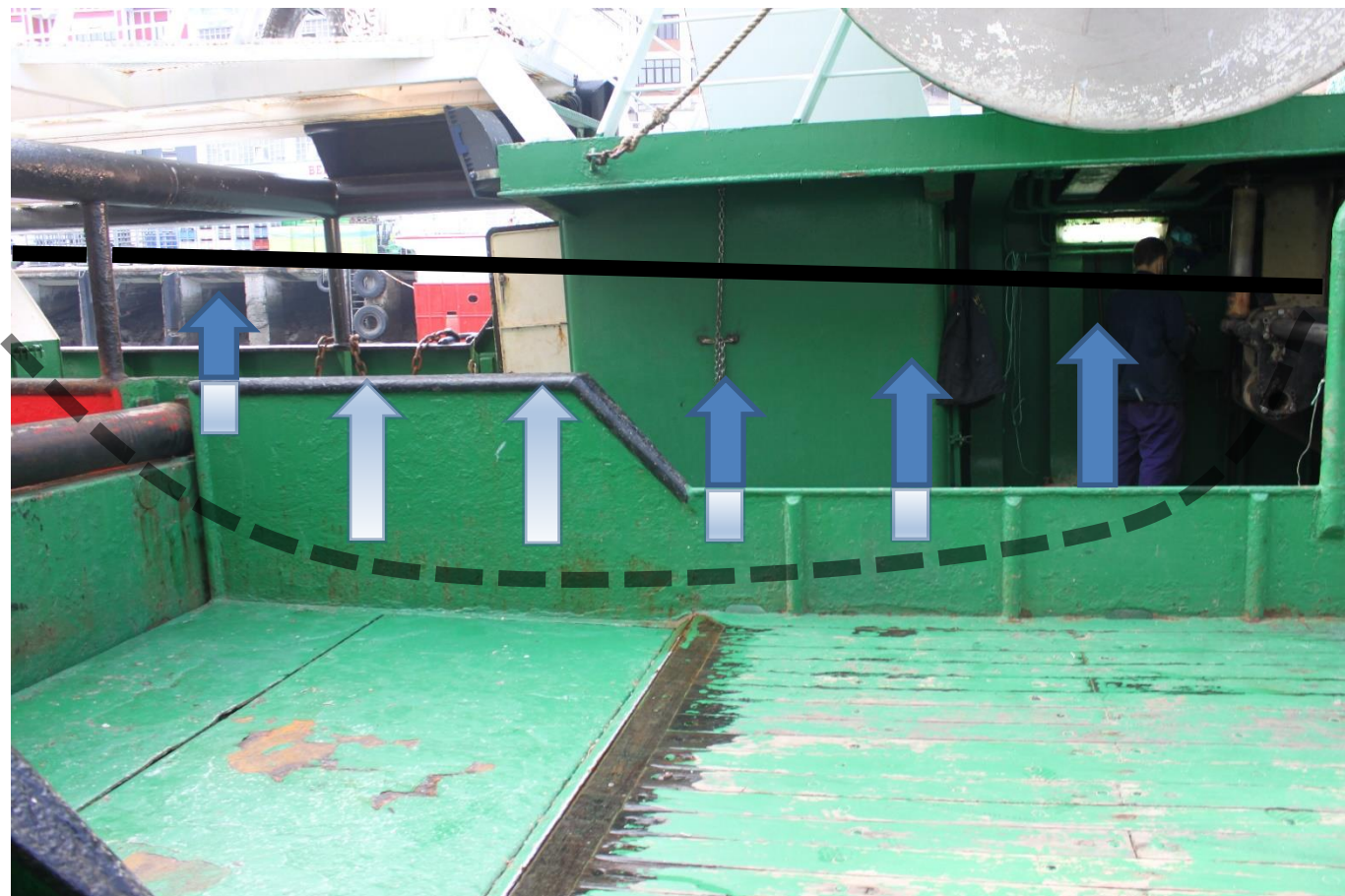
Figura 14. Cable poniéndose repentinamente en tensión. Vista de la vía de salida hacia la parte central de la cubierta y zonas de proa.
