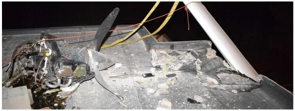
Ilustración 11: Detalle de cómo quedó el motor de la aeronave
