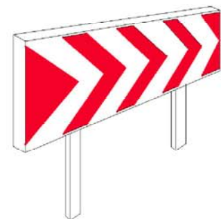
PANELES DIRECCIONALES PARA CURVAS
