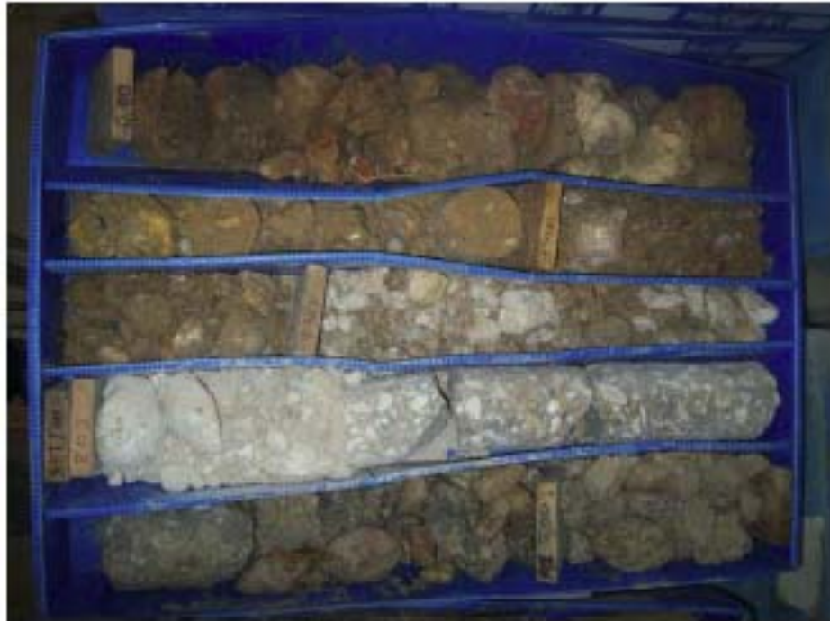
SONDEO S-2 Caja 1 de 10 De 0,00 a 3,20 m
