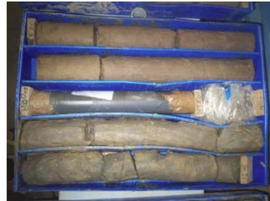
SONDEO S-2 Caja 3 de 10 De 6,80 a 10,40 m
