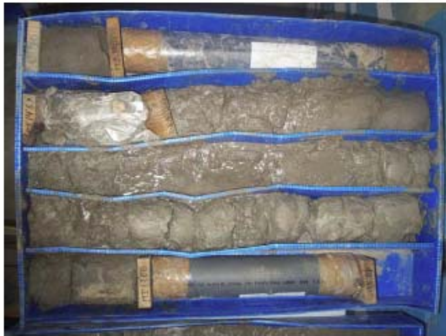
SONDEO S-2 Caja 5 de 10 De 13,40 a 17,60 m
