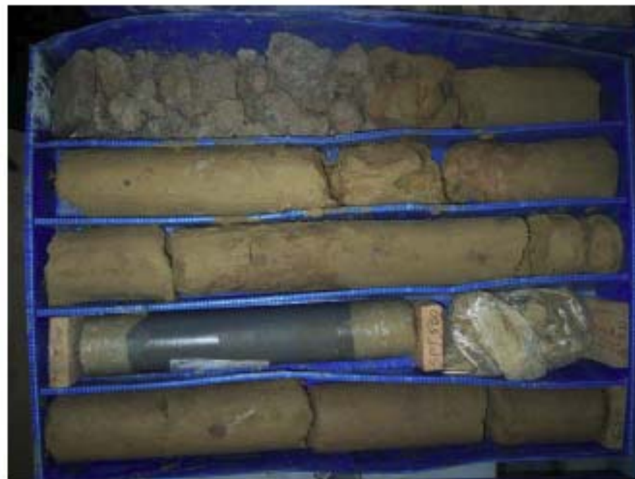
SONDEO S-2 Caja 2 de 10 De 3,20 a 6,80 m
