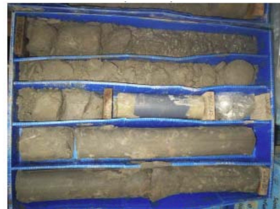
SONDEO S-2 Caja 8 de 10 De 25,40 a 29,40 m
