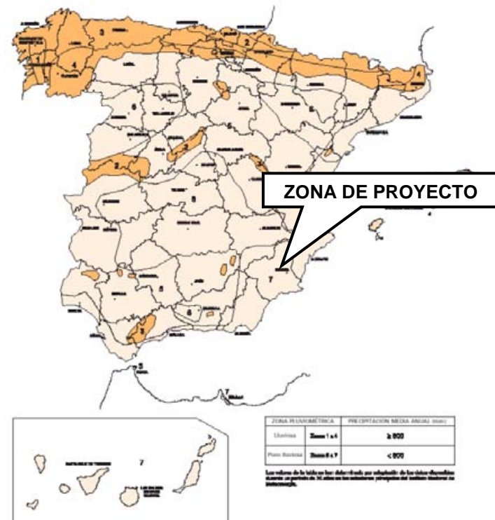
FIGURA 4 de la NORMA 6.1-IC. ZONAS PLUVIOMÉTRICAS
