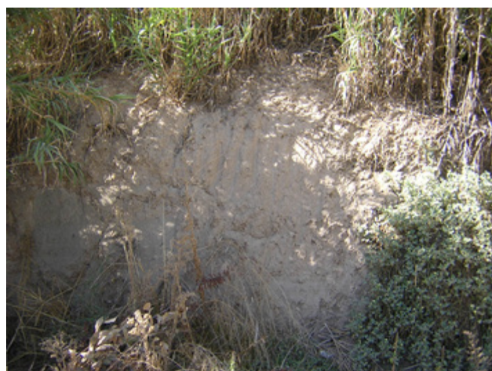
Fotografía 1. Depósito aluvial de naturaleza areno-arcillo-limosa localizado en la barriada de la Bobadilla.
