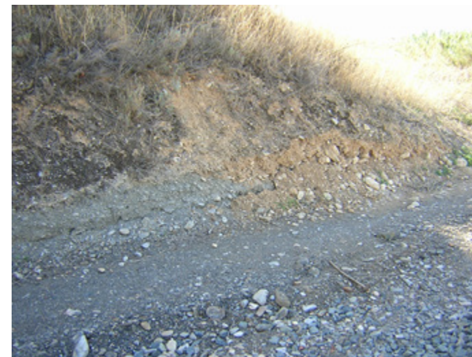
Fotografía 2. Depósito aluvial de naturaleza gravo-arenosa localizado en la barriada de San Fernando.
