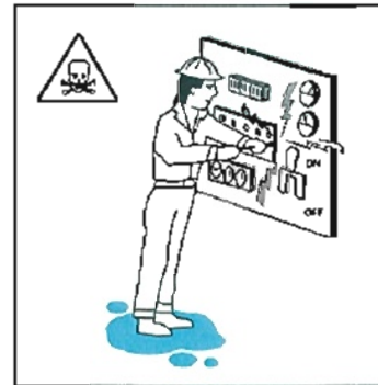
REPARACION DE EQUIPOS BAJO TENSION
