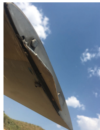
Ilustración 1. Detalle de los daños ocasionados por el impacto con el cable
