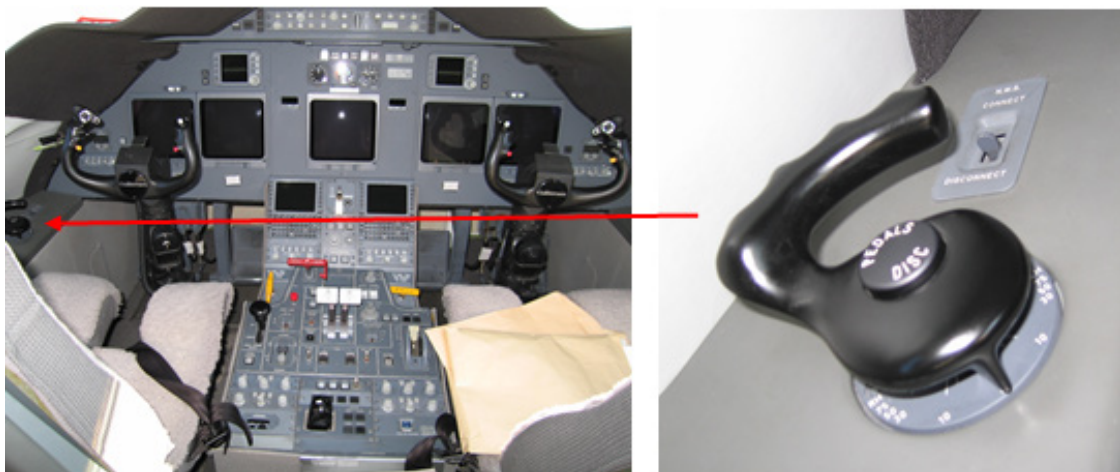
Fotografía 7: Volante de dirección situado en el lado izquierdo de la posición del comandante e interruptor del NWS.
