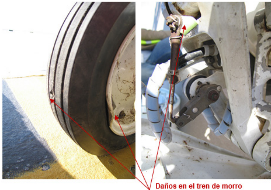
Fotografía 2: Daños en la rueda de morro y el brazo (bracket) en la rueda de morro
