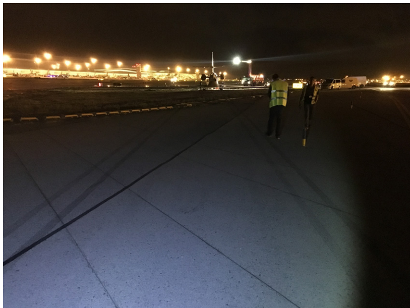
Fotografía 9: Situación final de la aeronave poco después del incidente con las huellas de frenado en la pista.
