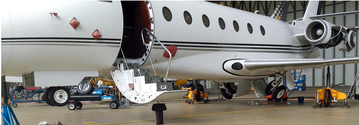
Fotografía 6: Retracción del tren de la aeronave puesta sobre gatos hidráulicos.
