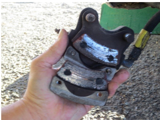
Fotografía 10. Zapatas, pastillas y material de fricción de frenos de rueda izquierda
