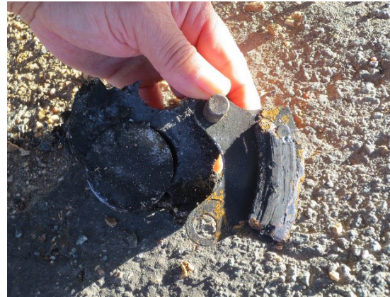
Fotografía 13. Zapatas, pastillas y material de fricción de frenos de rueda derecha
