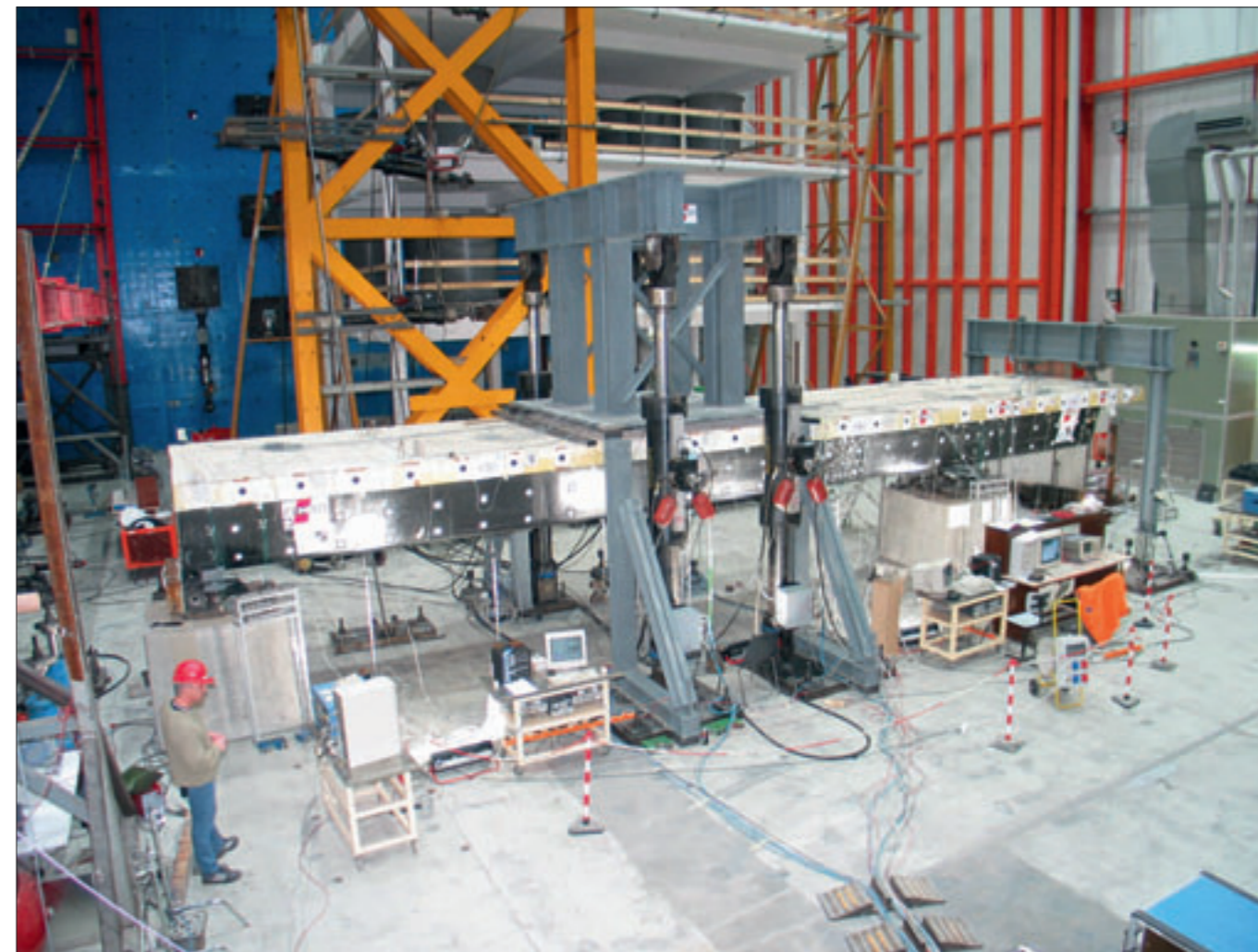
Fabricación de una de las vigas (arriba) y prueba de carga sobre el paso superior asturiano (debajo).
