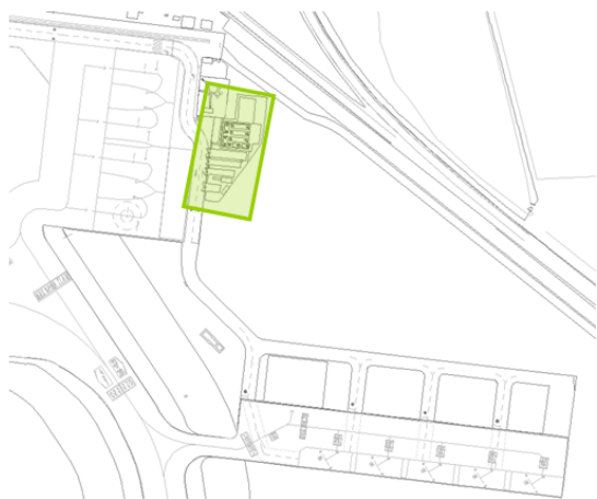
Ilustración 2.13.- Zona destinada al almacenamiento combustible
