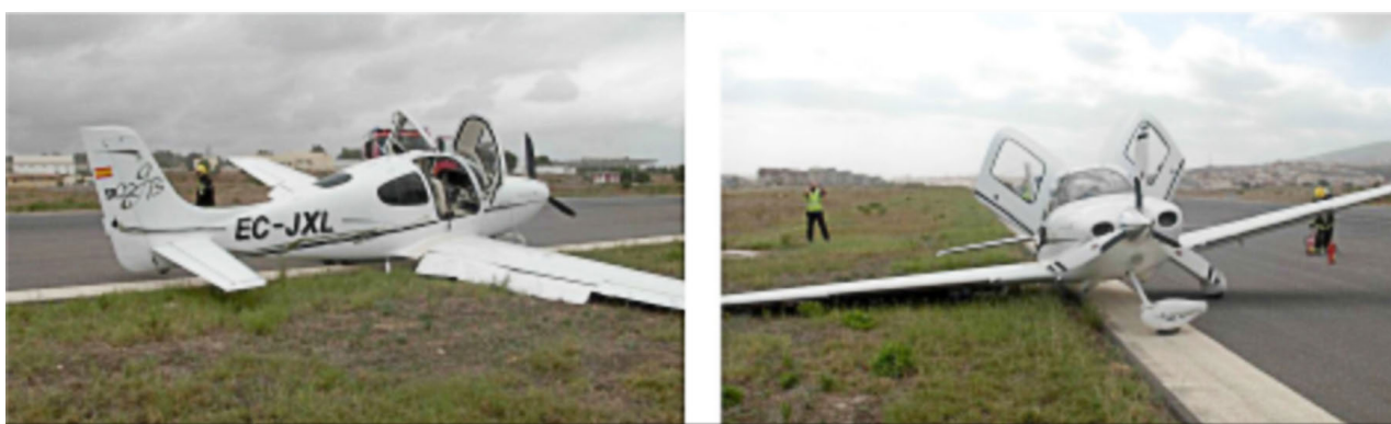
Figura 28. Daños producidos a la aeronave
