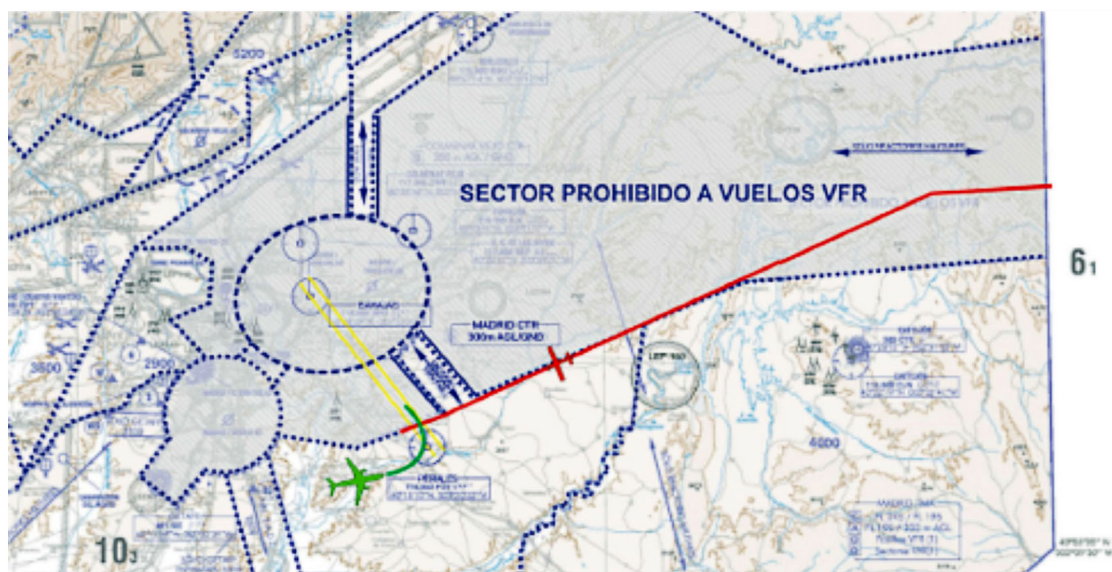
Figura 4. Carta de circulación VFR en el TMA de Madrid, con las trayectorias de las aeronaves Cessna (rojo) y A-320 (verde)
