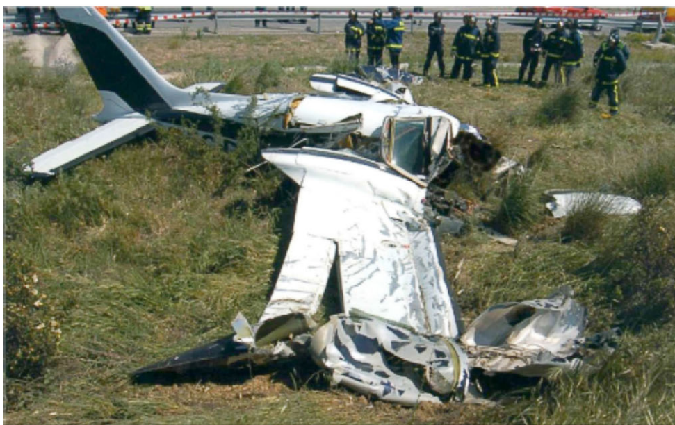
Figura 8. Estado de la aeronave tras el impacto
