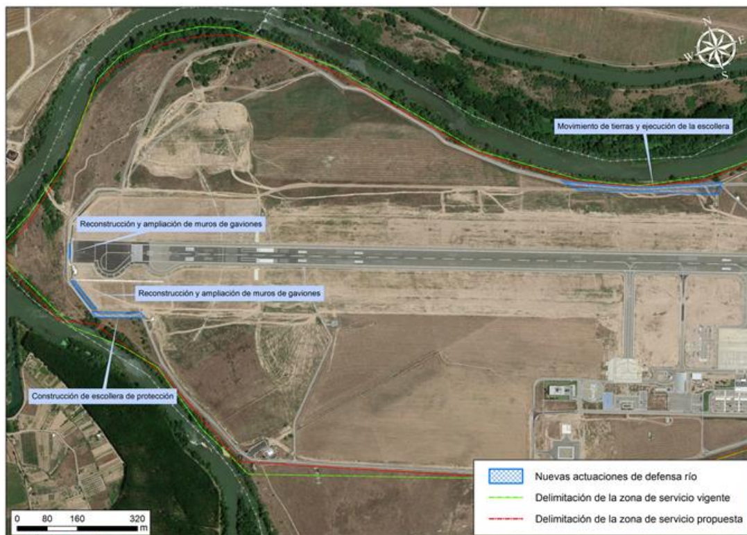
Figura 4.5 Actuaciones de protección de la infraestructura aeroportuaria
