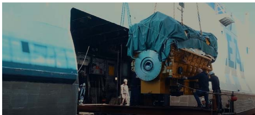
Figura 11. Vista de la introducción de uno de los motores principales a través de la cesárea practicada en el costado del barco durante la estancia del JAUME III en San Giorgio del Porto. (Fuente: video corporativo del astillero "San Giorgio del Porto").
