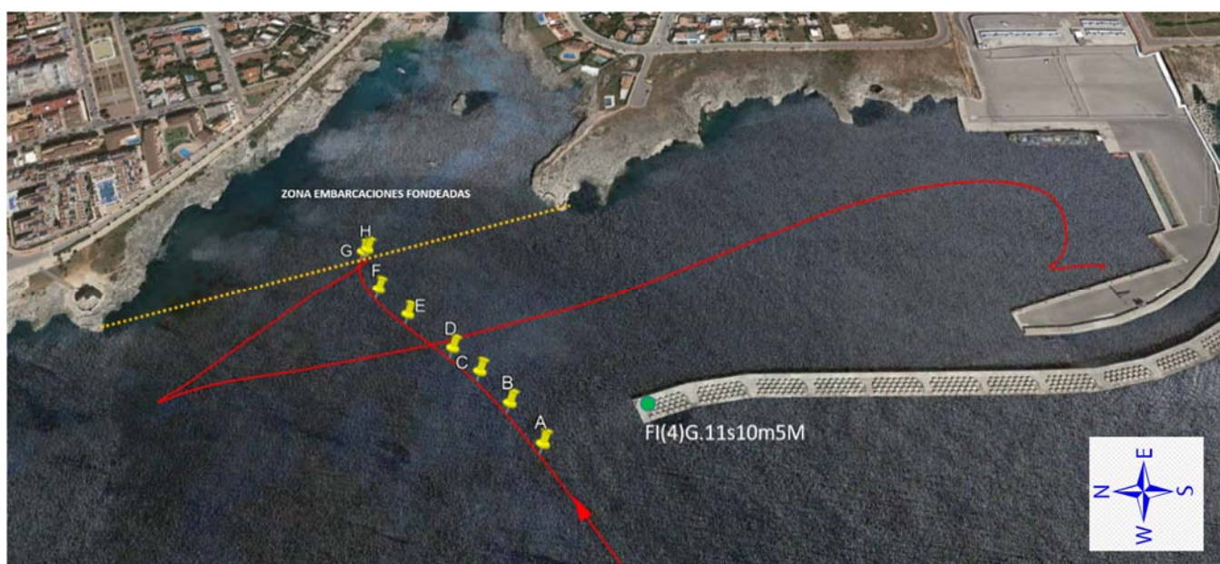
Figura 4. Secuencia de los sucesos de acuerdo con las grabaciones RDT desde el comienzo de la maniobra en el puerto exterior de Ciudadela hasta la recuperación del control de la nave. La línea roja indica la trayectoria seguida por el buque y la amarilla, el límite de las aguas portuarias. (Fuente: google earth)
