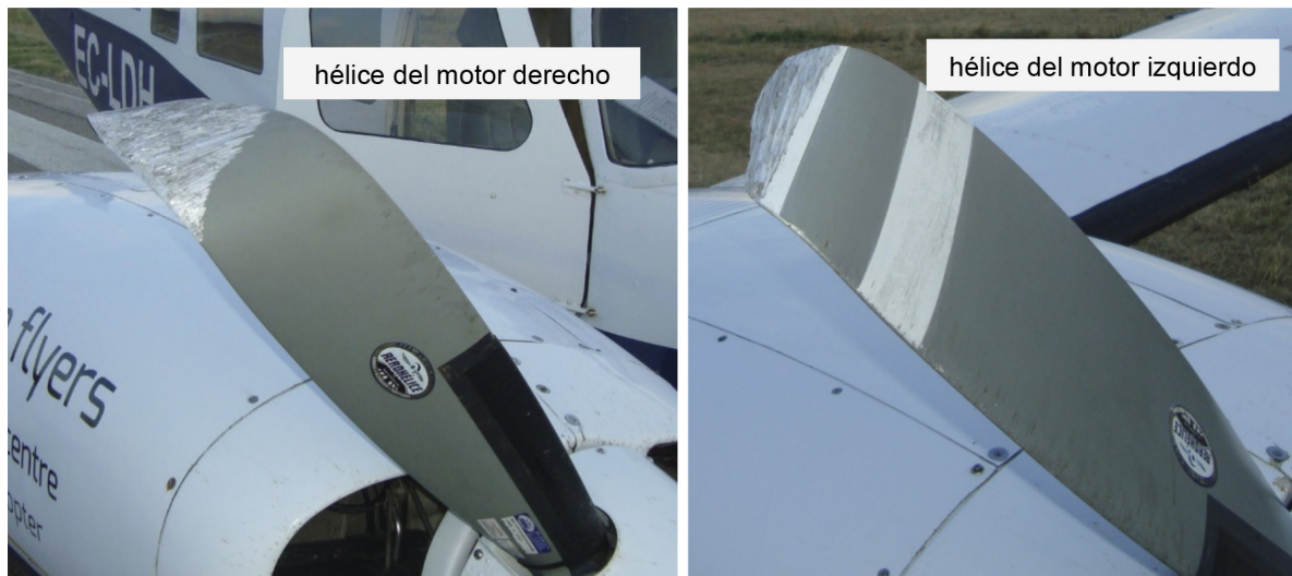
Figura 3. Daños en las hélices
