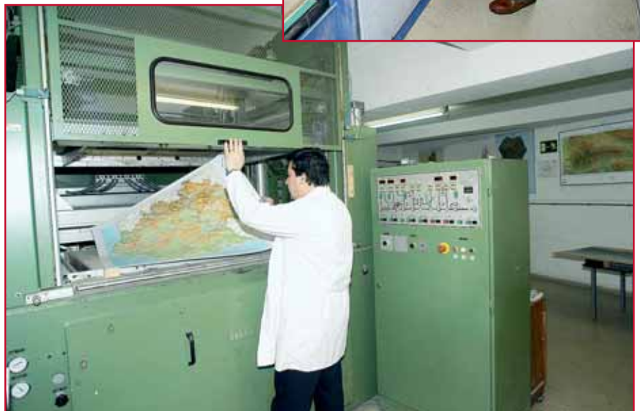
Vista parcial de la unidad de relieves con la fresadora de control numérico y la termomoldeadora.
