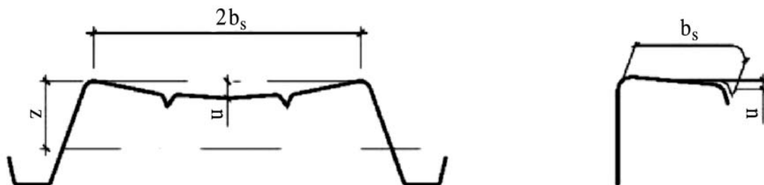
Figura 73.7. Combadura de alas (u)
