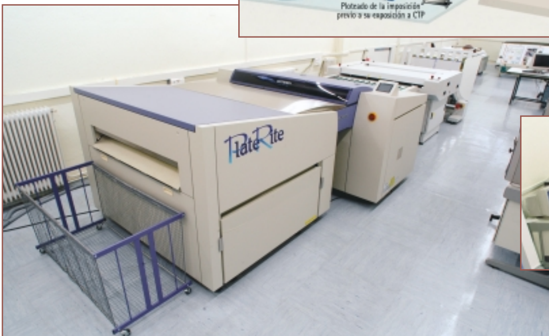
Vista general del equipo de filmación directa a plancha.
