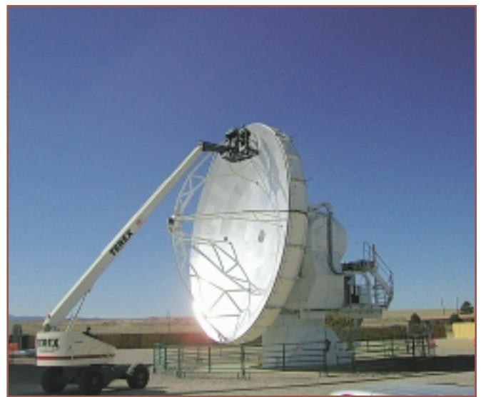
Sobre una plataforma elevadora, un ingeniero del IGN y otro estadounidense modifican la posición de los paneles de una de las antenas prototipo del proyecto ALMA. Siguiendo medidas por técnicas holográficas, los paneles han de desplazarse pequeñísimas fracciones de milímetro hasta lograr que el paraboloide de la antena se asemeje a un paraboloide ideal con la máxima precisión posible.
